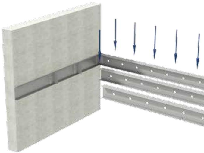
Montage avec équerres de fixation
